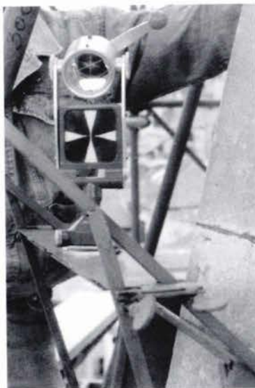
Slika 4. Mjerna mjesta na rebrima kupole i montirana Kernova prizma na priručnom postolju
