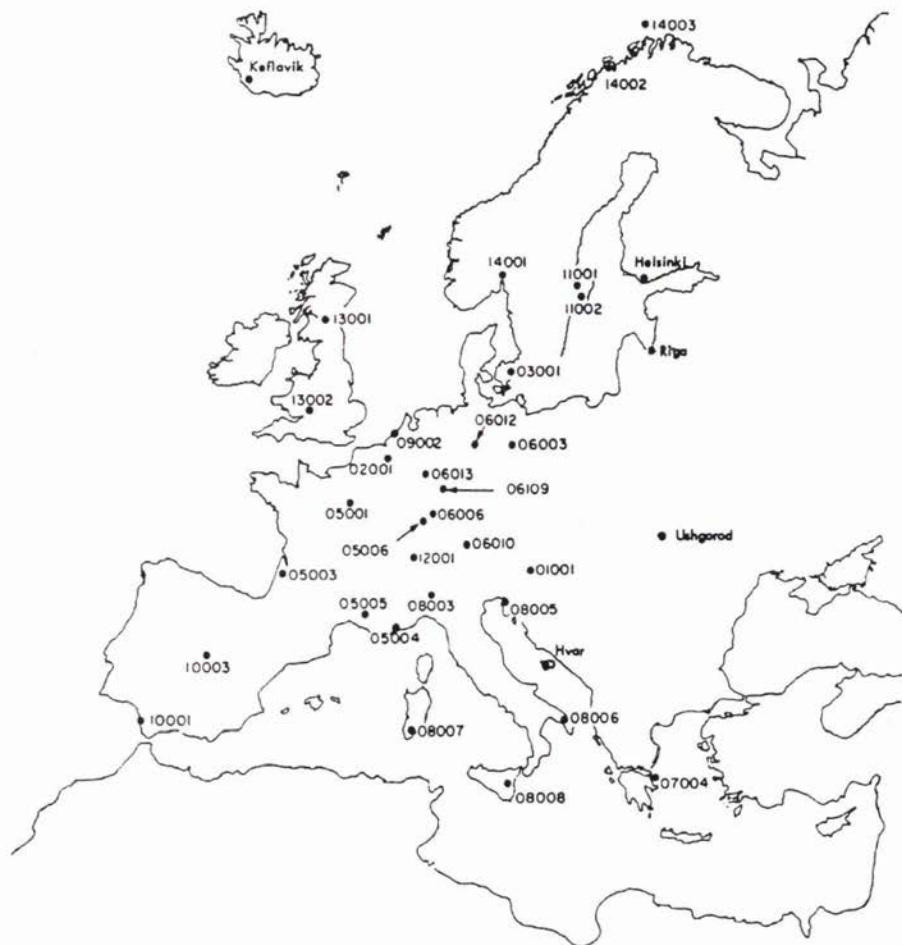
Slika 5. Raspored opažачkih stanica Zapadnoeuropskoga satelitskoga trigonometrijskog projekta WEST (1971-72. godine)
