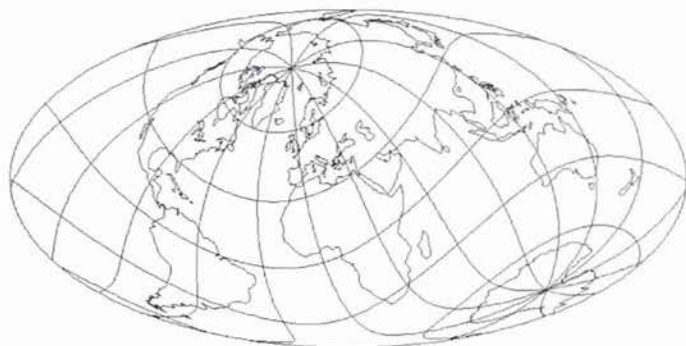
Slika 6. Kosa Mollweideova projekcija ( \lambda_0 = 20^\circ , \varphi_p = 50^\circ , \lambda_p = -40^\circ )
