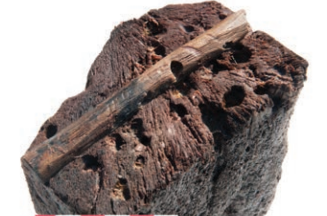
Sl. 32 Čivija na dislociranom brodskom rebru W20 (fotografija: L. Damelet). Fig. 32 Treenail driven into the displaced frame W20 (photo by: L. Damelet).
