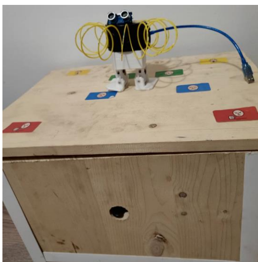
Slika 7. Izrađeni robotski sustav s kućištem
