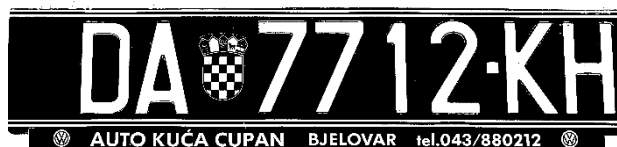
Slika 6. Slika registarske pločice nakon binarnoga ograničavanja i invertiranja slike
