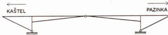
Slika 2. Plitki trozglobni okvir mosta s poprečnim presjekom.
