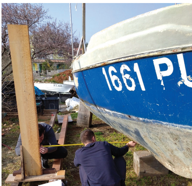
Figure 7 Procedure for measuring the distance of the marked offsets from the vertical lath Slika 7. Postupak mjerenja udaljenosti označenih točaka od vertikalne letvice
