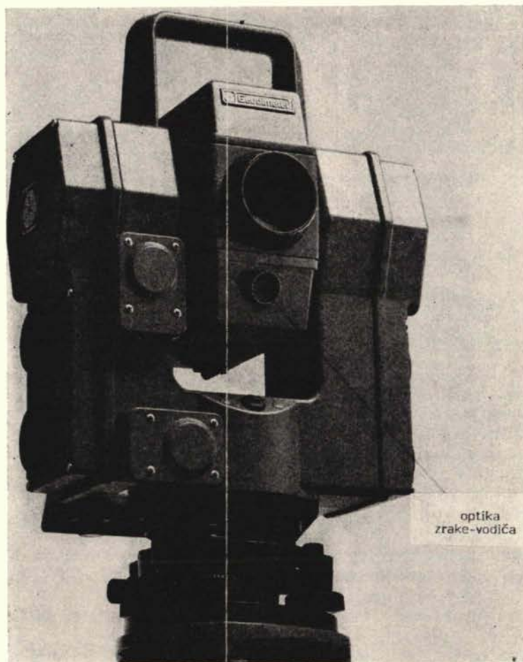
Slika 1. Geodimeter 400 s ugrađenom »vodič« zrakom
