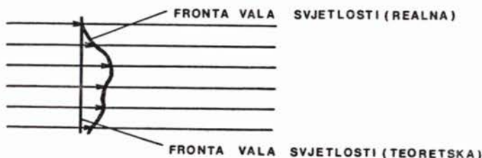
Slika 1. Fronta vala kakva bi teorijski trebala biti, da daljinomjer nema pogrešaka i fronta kakva realno iz daljinomjera izlazi
