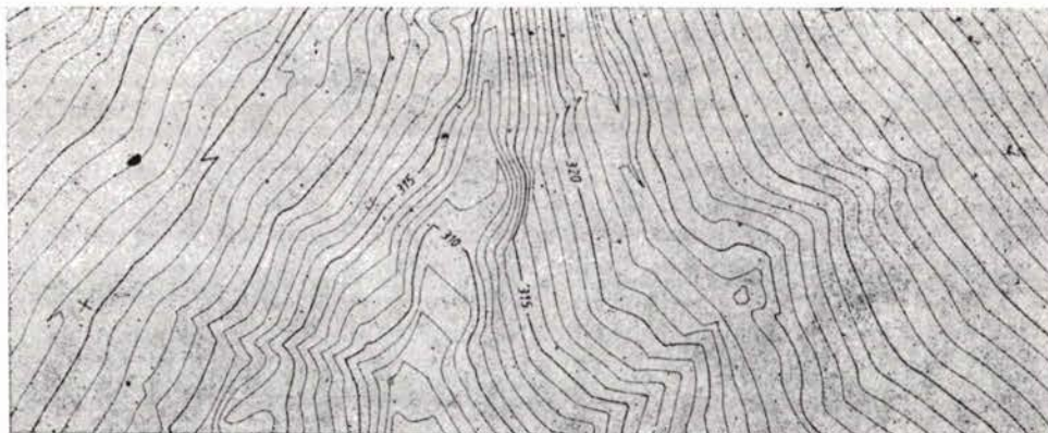
Slika 2. Primjer iscertavanja slojnica na ploteru, koji je dio sistema TOPOCAM
