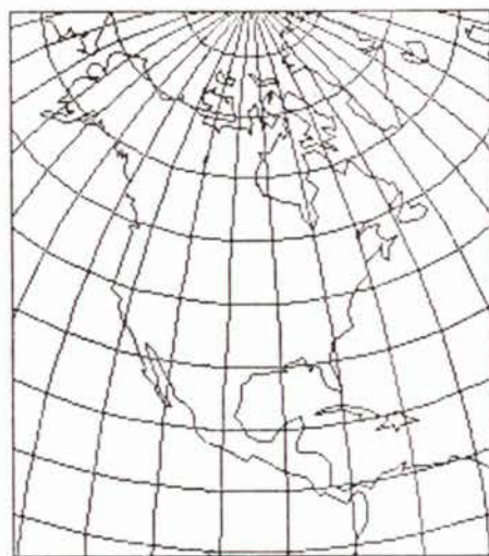
Sl. 3. a) Bonneova projekcija, b) ekvivalentna azimutalna projekcija (Hewlett Packard 9845S, ugrađeni termalni štampač, rezolucija 560 \times 455 točaka)
