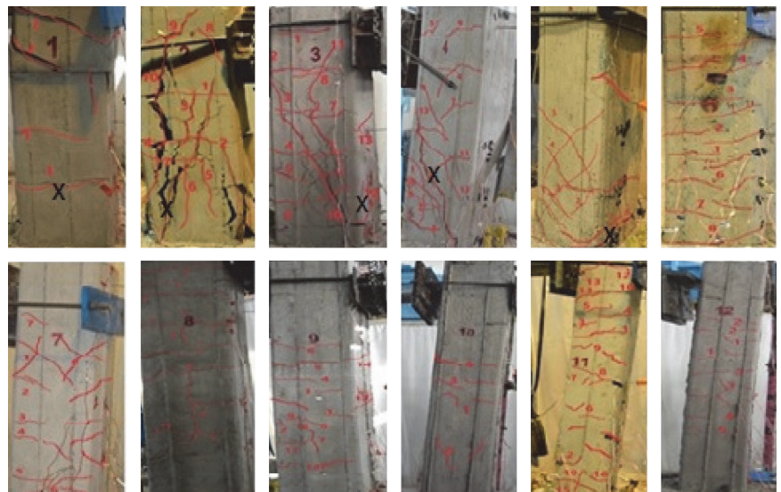
Slika 7. Obrasci pukotina na uzorcima nakon sloma
