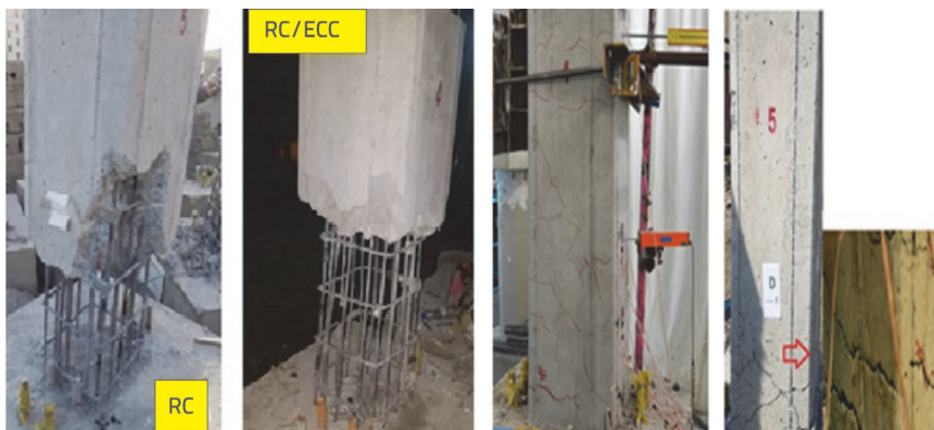
Slika 10. Mehanizmi sloma stupova SP4 (ECC) i SP5 (AB)
