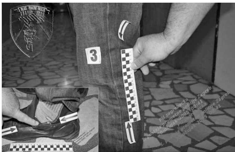
Slika 39: Oštećenje čarape nastalo kontaktom s papučicom kvačila 23
