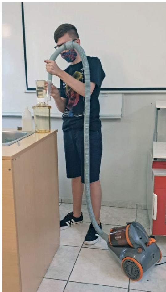
Slika 6b. Alternativni načini nadomjestaka vakuumske pumpe Autor: Mihaela Marceljak Ilić
