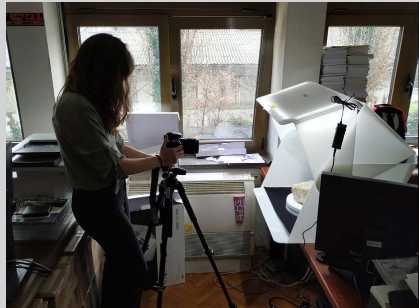
Sl. / Fig. 3 Dokumentiranje skulpture za potrebe fotogrametrijske izrade 3D modela a) van muzejskog konteksta, uz pomoć tzv. boxa za fotografiranje, 2021., autor: Filip Lovrić; b) unutar muzeja, točnije Gradskog lapidarija otoka Raba, 2021., autorica: Palmira Krleža
