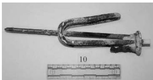
Slike 8 i 9: Električni bojler u kupaonici i neispravan grijač
