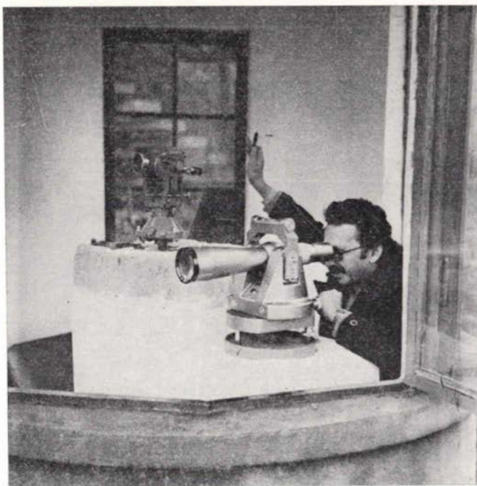
Sl. 2 Stajališni stup za trigonometrijski i geometrijski alinjan zaštićen kućicom
