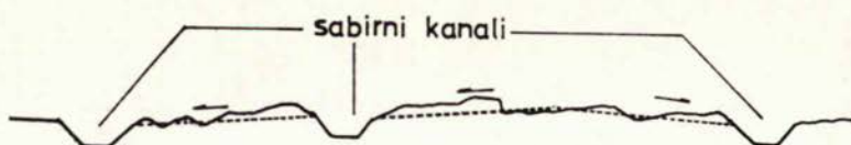
Sl. 1. Ravnanje zemljišta za površinsko odvodnjavanje, uz davanje jednostranog i dvostranog pada terena
