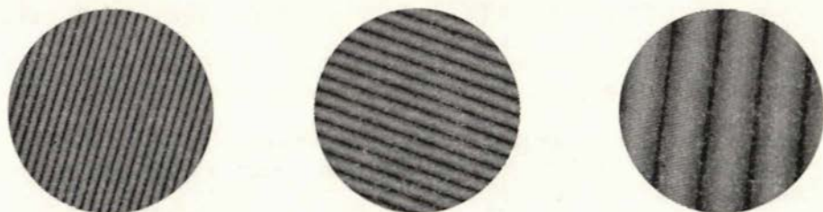
Sl. 2. Primjeri nepravilnog uglovanja rastera
