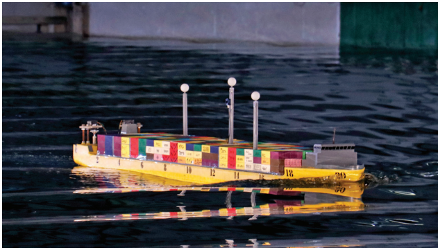
Figure 11 Seakeeping experiment at heading 180° Slika 11. Ispitivanje uz smjer 180°
