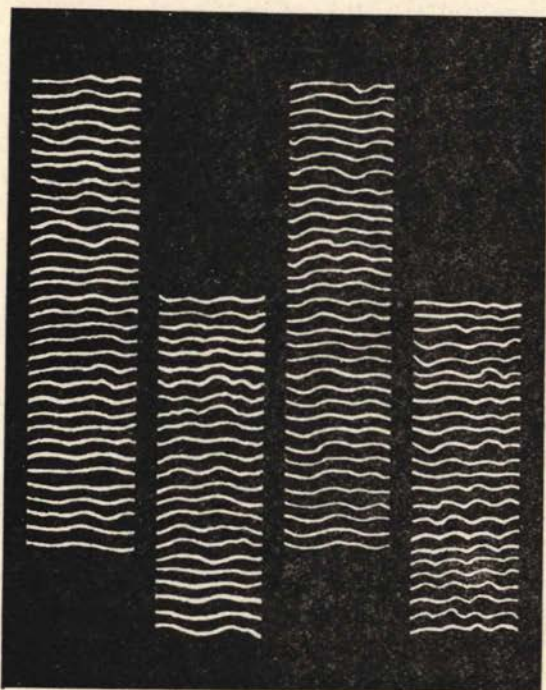
Sl. 3 — Staklena ploča sa ugraviranim visinskim profilima
