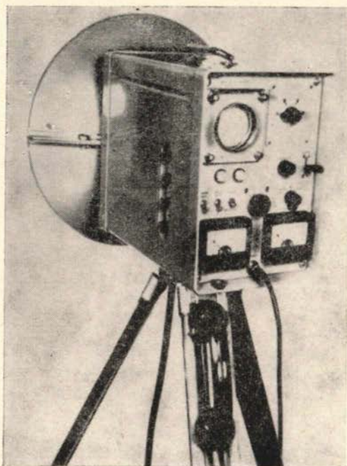
Slika 1 — Novi elektronski visokofrekventni mikrotalasni radio daljinomer tipa GET-B 1
