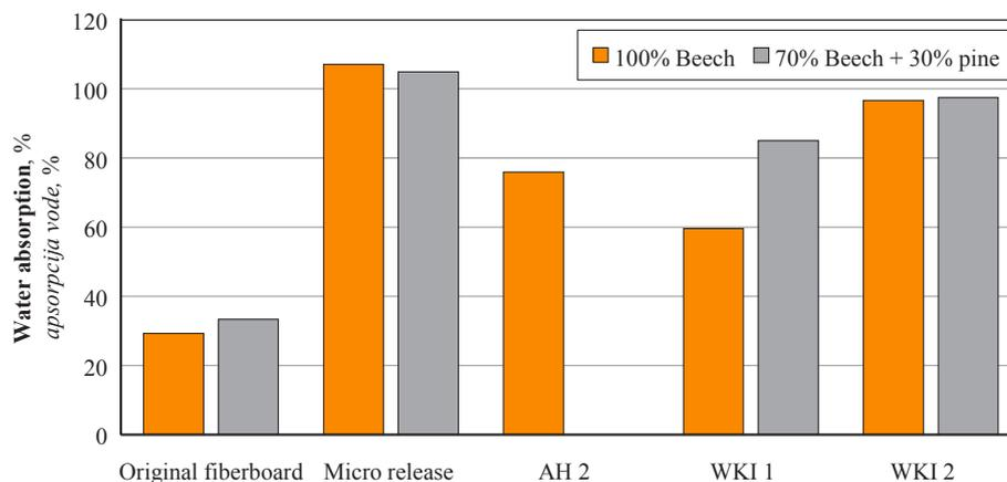
**Figure 1** 24 h water absorption values of tested boards**Slika 1.** Vrijednosti apsorpcije vode ispitivanih ploča nakon 24 sata
