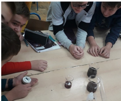
Slika 3 Mjerenje brzine širenja čestica octa kroz medije u tri različita agregacijska stanja
