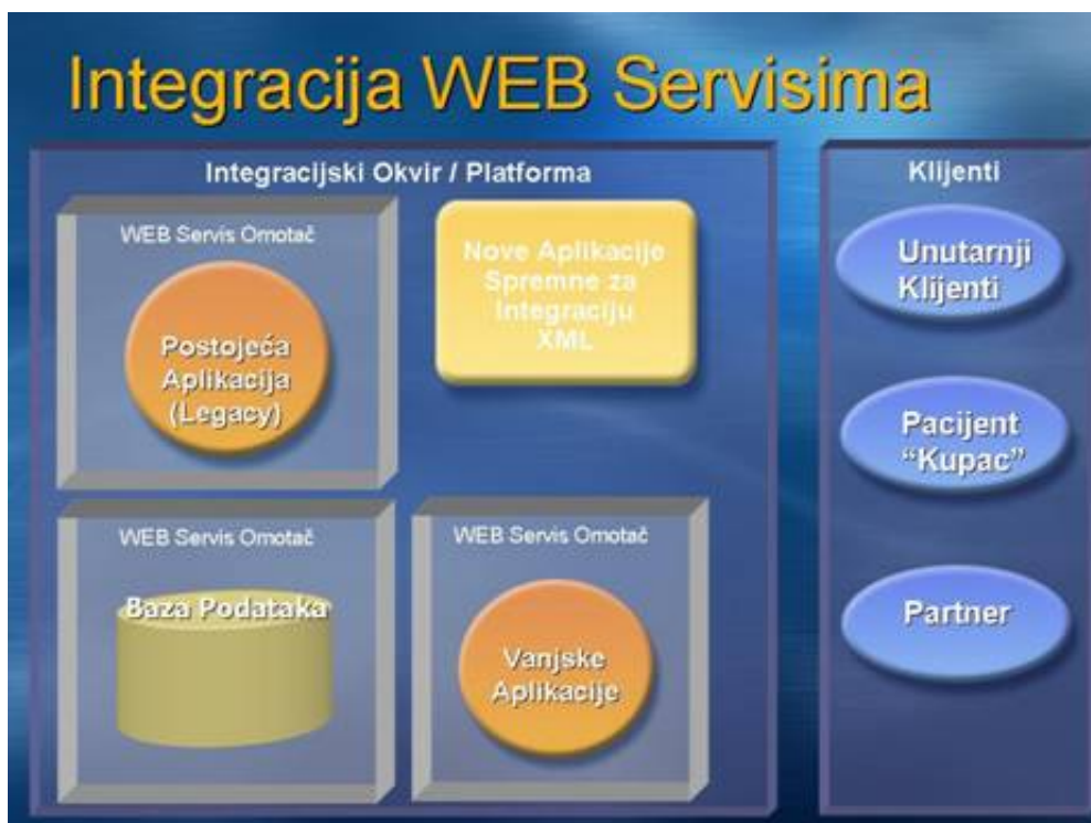
Slika 2. Logički prikaz sustava integriranog pomoću web servisa
