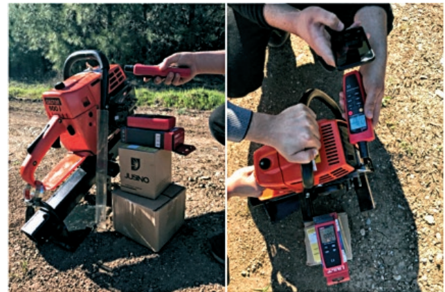
Slika 2. Dizajn eksperimentalne studije mjerenja CO vrlo blizu ispuha motorne pile
