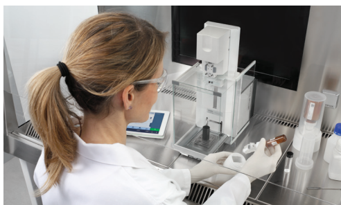
Slika 1 – Automatska vaga XPR može se upotrebljavati za ručne operacije, kao i za samostalno doziranje tekućina i praha
