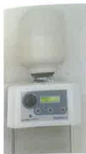
Slika 6. Uređaj za automatsko doziranje sadre i vode (ljubaznošću Denta –T)
