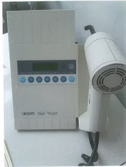
Slika 1. Kvarc-tungsten halogeni polimerizacijski uređaj.
