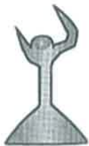
Slika 6. Veliko izbočenje s unutarnje stijenke odljeva (preuzeto iz 3).
