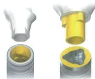
Slika 3. Unutarnji spoj (lijevo konusni dosjed sa heksagonom, desno cilindrični dosjed sa žljebovima).
