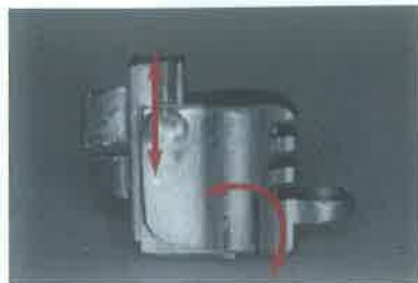
Slika 12. Dijelovi Ceka pričvrstka (preuzeto iz 11)
