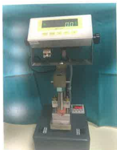
Slika 5. Uređaj za mjerenje jačine adhezijske sveze (Ultra Tester, Bond Strength Testing Machine, Ultradent Products, Inc., South Jordan, UT, USA)
