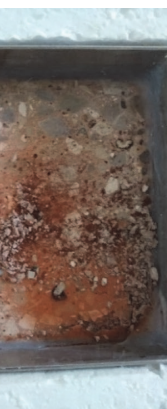
Slika 6. Postupak ispitivanja otpornosti na smrzavanje i odmrzavanje s otopinom natrijeva klorida
