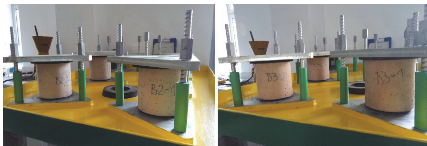
Slika 3. Postupak ispitivanja prodora vode (mješavine B2 i B3)
