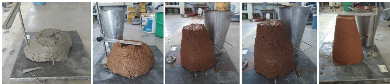
Slika 2. Ispitivanje obradivosti betonskih mješavina B1-B5 (slijeva nadesno)
