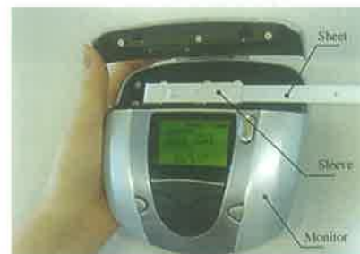
Slika 1. Uređaj za mjerenje aktivnosti salivarne amilaze. Preuzeto i prilagođeno iz (40).
