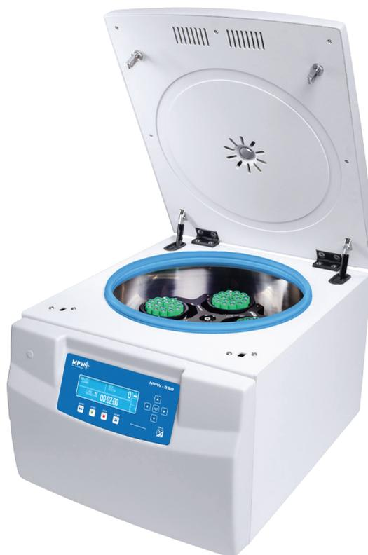
Centrifuge imaju indukcijski motor koji ne zahtijeva održavanje, automatsko prepoznavanje rotora, USB sučelje za spajanje na računalo, zaštitu putem lozinke/blokiranje određenih funkcija te mogućnost programiranja 99 korisničkih programa i 10 višesegmentnih rampi ubrzanja i usporavanja.
