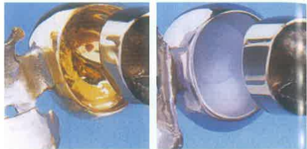
Slika 11 a i b. Ispitivanje frikcije: zlato/FGP
