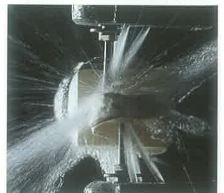
Slika 18. Freziranje keramičkog bloka (preuzeto iz 11)
