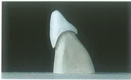
Slika 10. Jezgra nakon sinteriranja (preuzeto iz 5)
