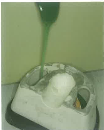
Slika 7a. Ulijevanje mase za dubliranje (hidrokoloid) u kivetu
