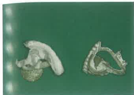
Slika 20. Metalni skelet nakon oslobađanja iz kalupa od uložne mase
