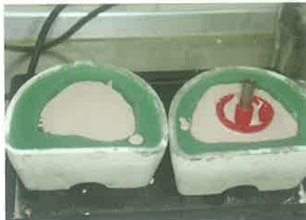
Slika 12. U kalupe od mase za dubliranje ulijeva se masa za ulaganje
