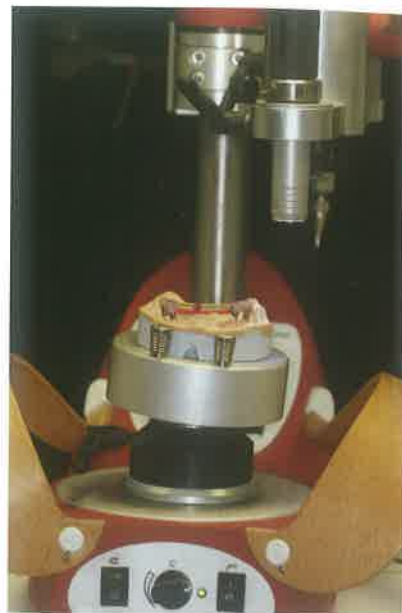
Slika 20. Gornji radni model s izmodeliranom individualno frezrenom prečkom VSP sustava u paralelometru.
