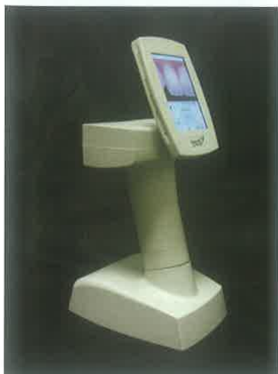
Slika 5. Spektrofotometar za oralnu primjenu SpectroShade Micro (MHT, Verona, Italija).
