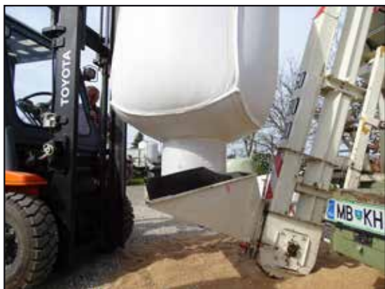
Slika 2. Neočišćeno sjeme iz jumbo vreće preko prihvatnog lijevka ulazi u uređaj – stroj za čišćenje sjemena.
