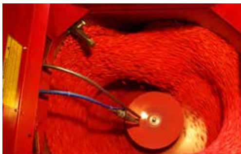
Slika 10. Komora za miješanje u kojoj se sjeme tretira odgovarajućim sredstvima za zaštitu bilja. Izvor slike: Cimbria
