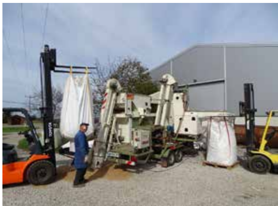
Slika 1. Mobilni uređaj za doradu žitarica sa čistačem žitarica i uređajem za tretiranje sjemena.
