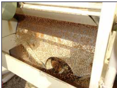
Slika 3. Već djelomično pročišćeno sjeme pada iz vertikalnog aspiracijskog kanala prema horizontalnom cilindričnom bubnju. Figure 3 Already partially purified seed falls from the vertical aspiration channel towards the horizontal cylindrical drum.
