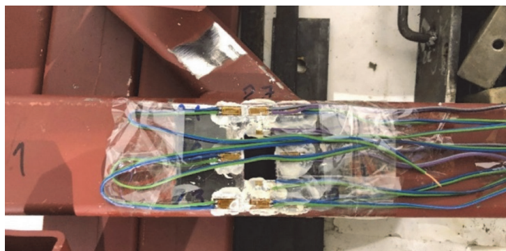
Slika 15. Raspored tenzometara na uzorku s oštećenjem 2 (Y-priključak_D2)
