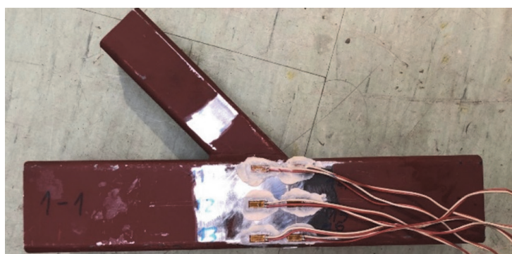
Slika 14. Raspored tenzometara na uzorku bez oštećenja (Y-priključak_ND)
