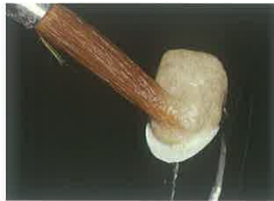
Slika 5. a) i b) Nanošenje i infiltracija staklom aluminijske jezgre keramike sljip casting tehnikom (preuzeto iz 12)
