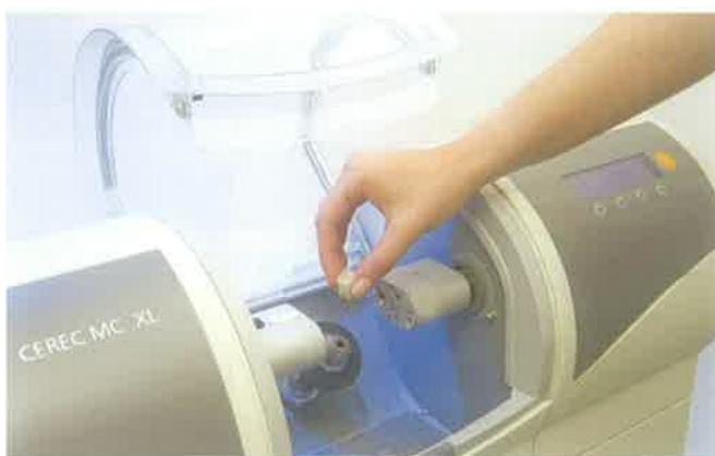
Slika 3. Sirona dental CEREC CAD/CAM sustav. Preuzeto iz 6.
