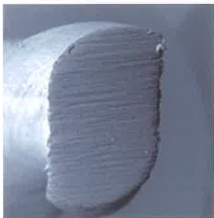
Slika 7. Presjek Reciproc instrumenta. Preuzeto iz (18).
