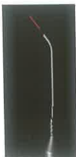
Slika 1. 3D fiber optički nastavak diodnog lasera (Helbo Photodynamic System, Bredent, Senden, Njemačka)
