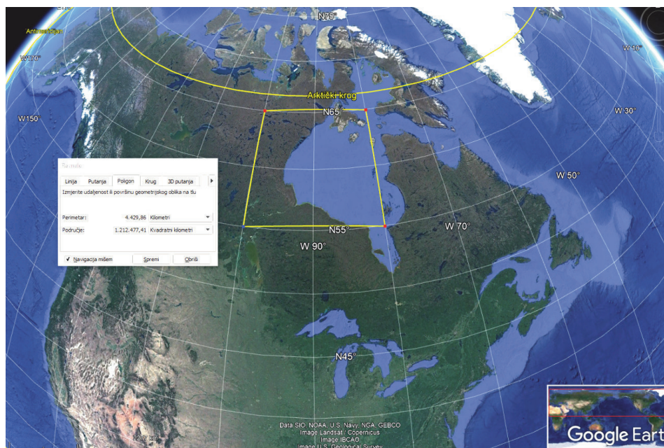
Slika 1. Određivanje površine geodetskog poligona u sredini karte.
