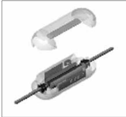
Fig. 19. Distributed FACTS device Sl. 19. Distribuirani FACTS uređaj
